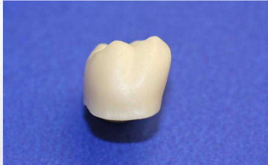
Corona despues de sinterizarse
